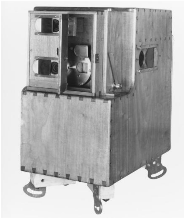
ଚିତ୍ର ୦୪: ଚଳଚ୍ଚିତ୍ର ଛବିକୁ ଫିଲ୍ମରେ ପରିଣତ କରିବା ପାଇଁ ୧୮୮୮ରେ ଲିପ୍ରିନ୍ଙ୍କ ଦ୍ୱାରା ଉଦ୍ଭାବିତ ଗୋଟିଏ ଲେନ୍‌ସ୍ ବିଶିଷ୍ଟ କ୍ୟାମେରା, ସାଇନ୍ସ୍ ମ୍ୟୁଜିୟମ୍ ଗ୍ରୁପ୍ କଲେକ୍ଟନ୍ ସ୍ୱର୍ଗ୍- ଦ ବୋର୍ଡ୍ ଅଫ୍ ଟ୍ରଷ୍ଟିଜ୍ ଅଫ୍ ଦ ସାଇନ୍ସ୍ ମ୍ୟୁଜିୟମ୍
